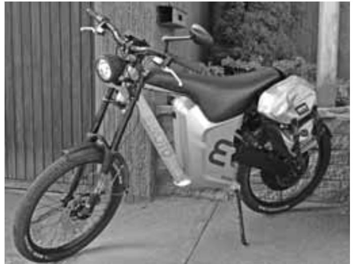
Das EnBW-E-Bike fährt mit einer Geschwindigkeit bis zu 45 km/h, abgasfrei und nahezu geräuschlos
